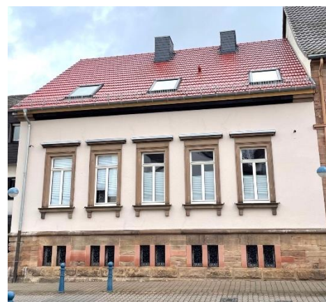
Harmonische Anordnung von Dachflächenfenstern. Bündiger Einbau ohne hervortretende Rollläden.
